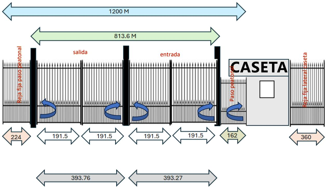
Las medidas en la imagen son relativas hasta contar con la instalación de los postes se tendrán medidas exactas para la fabricación de las rejas.
